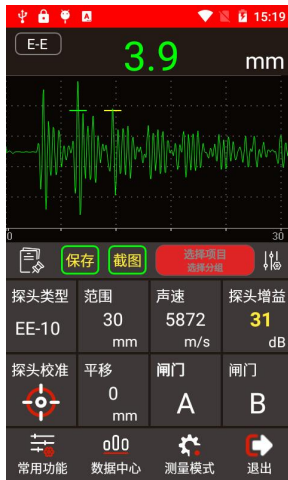
图 2 - 超声测厚 APP 的 A 扫测量界面
