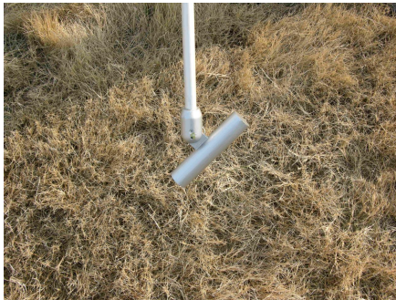
45 度法（探头于管线走向成 45 度角）
